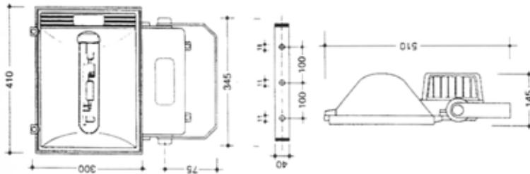
نورافکن ضدآب با قابلیت به کارگیری انواع لامپ های بخار جیوه، بخار سدیم و متال هالید در توان های ۱۵۰ ، ۲۵۰ و ۴۰۰ وات می باشد.
